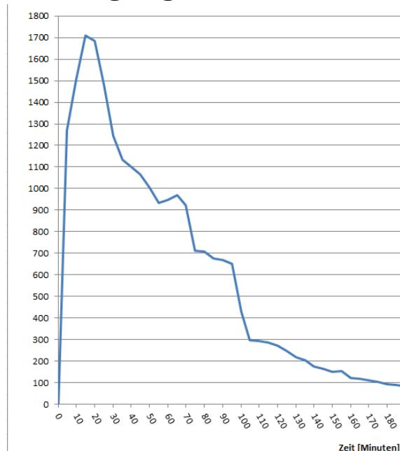
Für diesen Versuch wurden 800 g Holzkohlebriketts entzündet und das Abgas in einer provisorischen Abzugshaube gemessen. Es zeigte sich, daß der Großteil an CO innerhalb der ersten zwei Stunden freigesetzt wird. Laut der Literatur wären bei den im Versuch anfänglich erreichten 1700 ppm (0,17 %) in der Atemluft bereits nach wenigen Minuten mittelschwere Vergiftungssymptome (Schwindel, Übelkeit, stechende Kopfschmerzen) zu erwarten.
